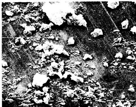
La foto mostra una immagine al microscopio a scansione del deposito di polveri. I grani più grossi sono di quarzo e le più piccole scaglie sono di argilla. I trattini bianchi sono lunghi un millesimo di millimetro.
